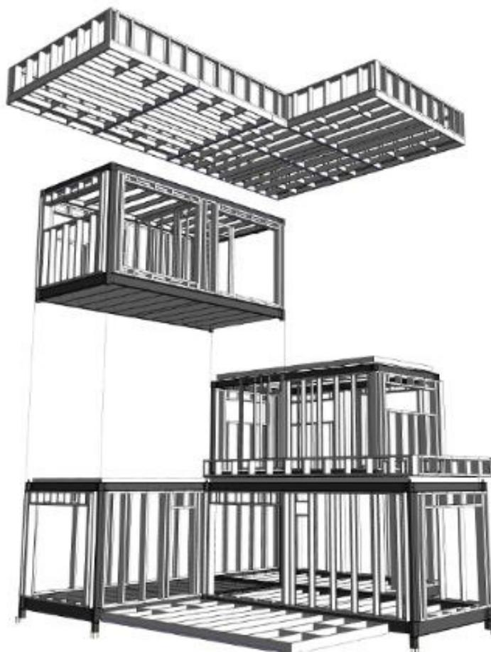
***Рисунок 10.4*** – Пример схемы стыковки модулей между собой и установки модулей на фундамент
