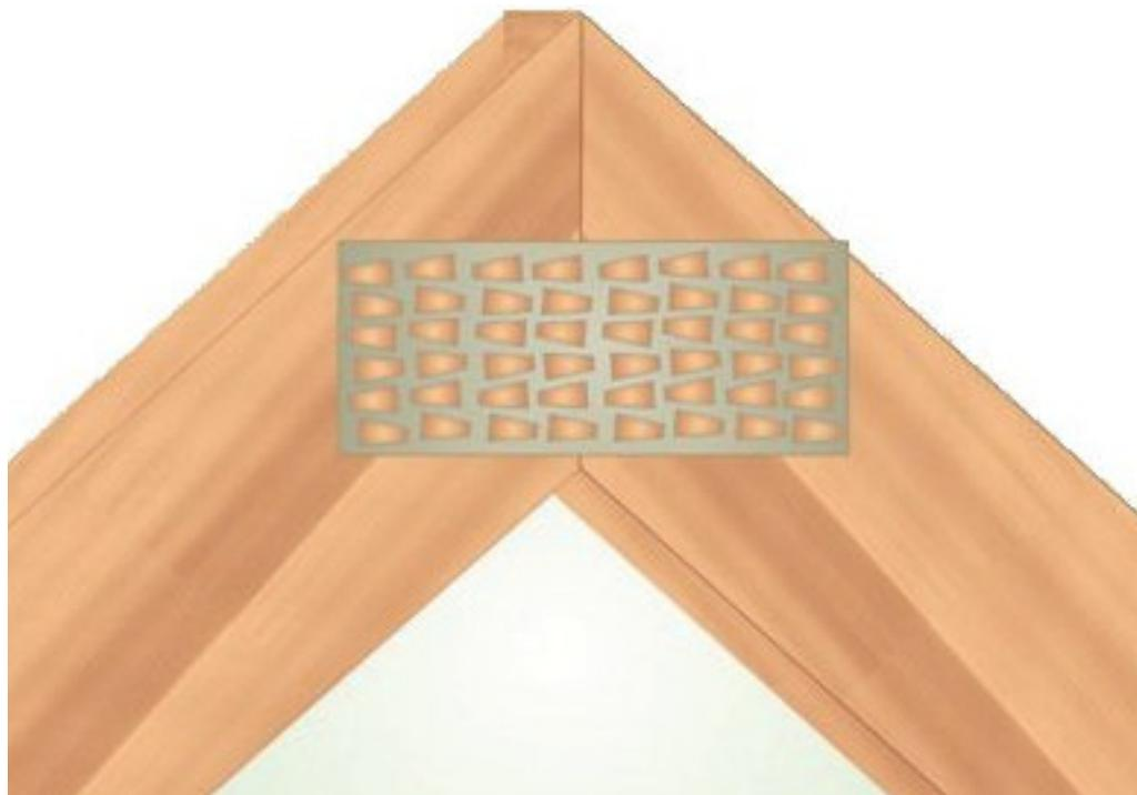
*a* – гвоздевая пластина; *б* – соединение на гвоздевых пластинах
