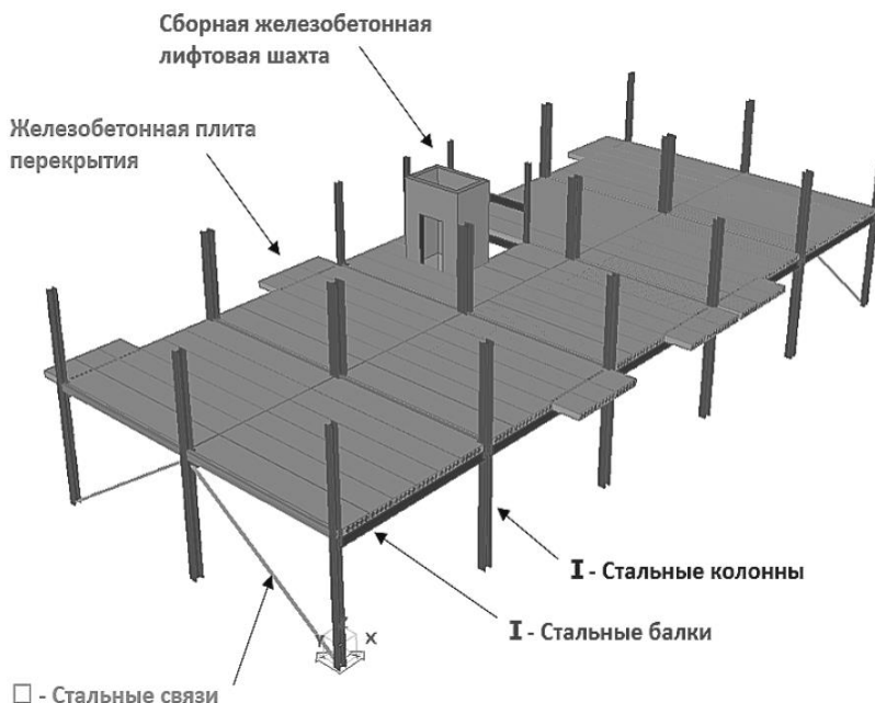
Рисунок 7.4– Рамно-связевый каркас со сборной шахтой лифта
