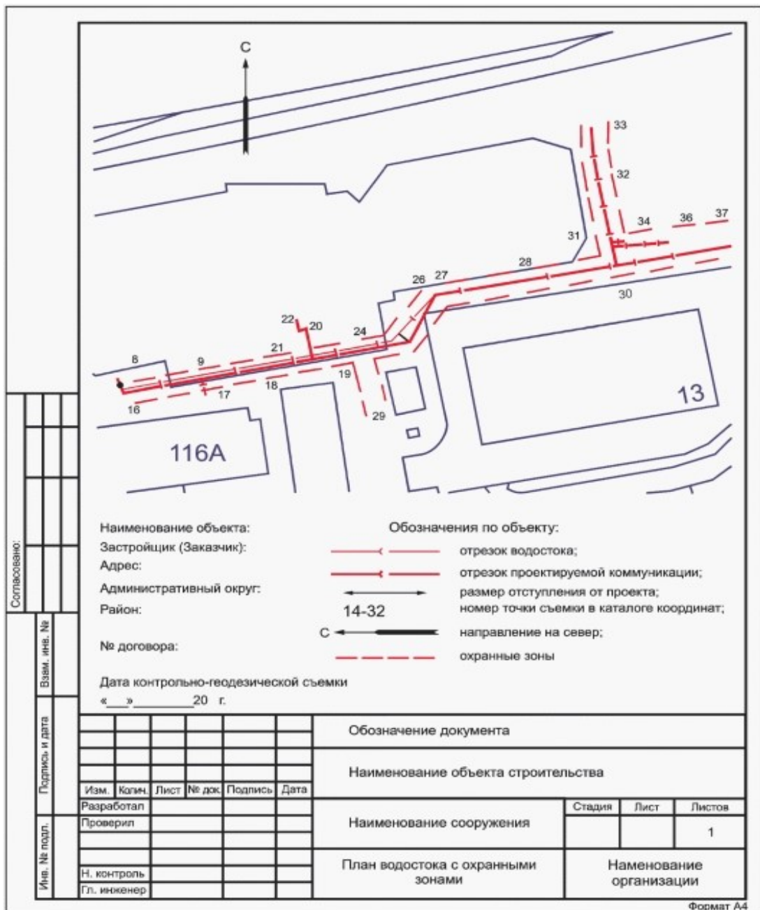
Рисунок В.1 – План водостока с охранными зонами
